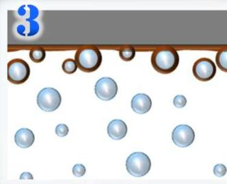
ファインバブルの帯電性により、汚れを吸着し、気泡表面に汚れを取り込みます
